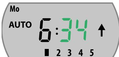
6. Utilisez les touches HAUT et BAS pour régler la minute souhaitée de l'heure de montée automatique pour le lundi.
