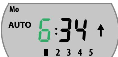
4. Utilice las teclas ARRIBA y ABAJO para ajustar la hora deseada de la subida automática del lunes.
